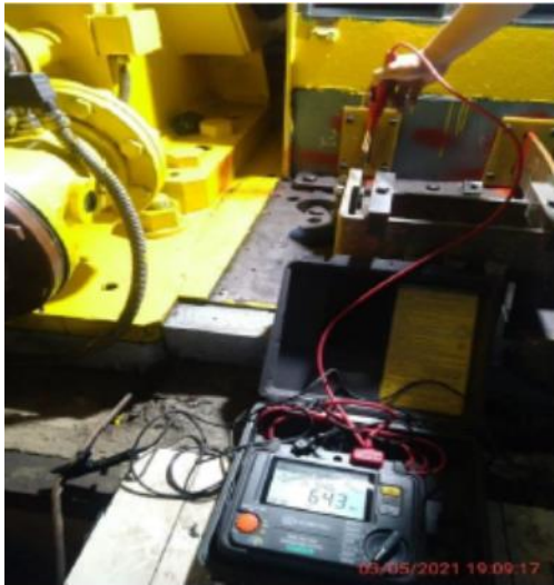
Gambar 6 Megger Sistem Hasil Positif
