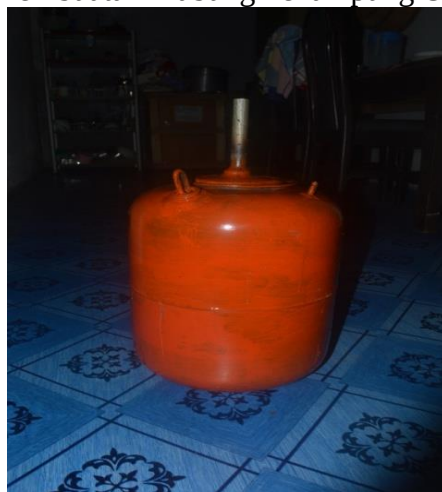
Gambar 4.1 Tabung Penampung Oli Defferential Sumber: Foto Lapangan
