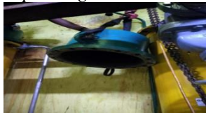
Gambar 4.5: pembongkaran flange oil cool
