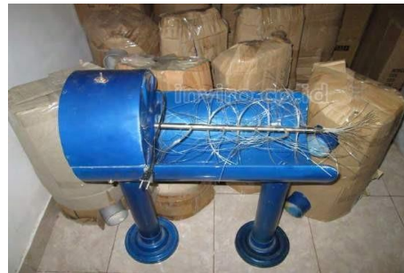
Gambar3. 2. Mesin penyikat galon semi otomatis (sumber: CV. IndoSolution. 2018)
