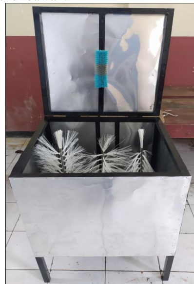
Gambar 4.5. Mesin Penyikat Galon Luar Dan Dalam Semi Otomatis (Sumber: dokumen pribadi)
