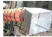
Gambar 4.6 Hood yang sudah terhubung ke selang dan frame
