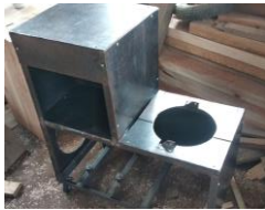
Gambar 4.4 Rangka Mesin yang sudah di pasang plat
