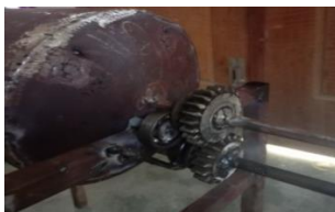
Gambar 4.3 Pemasangan Roda Gigi Sumber : DokumenPribadi
