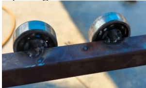
Gambar 4.2 Pemasangan bearing Sumber : DokumenPribadi
