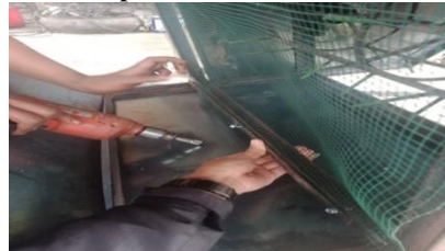
Gambar 4.6 Proses Penyambungan Ayakan
