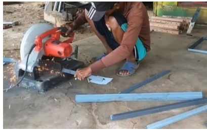
Gambar 4.1 Pemotongan Besi L
