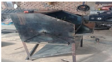
Gambar 4.9 Kerangka mesin perontok padi
