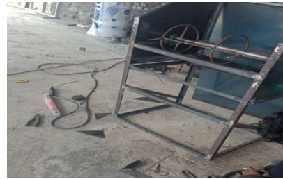
Gambar 4.4 Kerangka Mesin Perontok Padi
