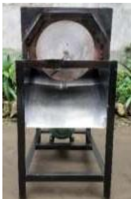
Gambar 4.10 Mesin perajang buah pisang
