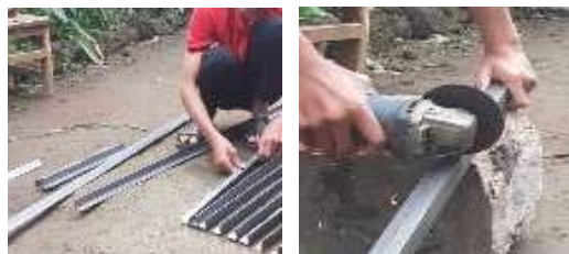
Gambar 4.1 Pemotongan besi siku kerangka
