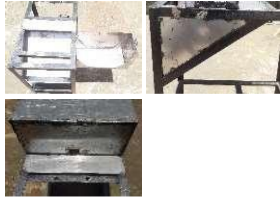
Gambar 4.6 Penyambungan cover pada kerangka
