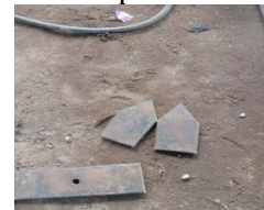
Gambar 4. 2 Proses Pembentukan mata pisau
