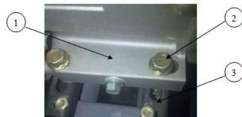
Gambar 4.13. Sambungan Mesin Ke Dudukan Mesin
